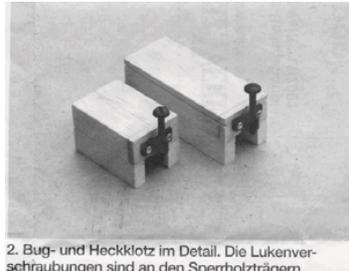
2. Bug- und Heckklotz im Detail. Die Lukenschraubungen sind an den Sperrholzträgern befestigt, die Nuten dienen zur Aufnahme der Schubstangenrohre.
