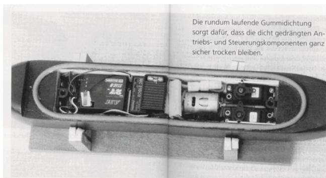
Die rundum laufende Gummidichtung sorgt dafür, dass die dicht gedrängten Antriebs- und Steuerungskomponenten ganz sicher trocken bleiben.
