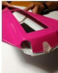
Dann wird die Kiellinie mit einem Malerband abgeklebt und die Maße eingezeichnet. Alle Maße werden vom Heck her gemessen. Hierfür gibt es eine Faustregel. Bei 10% der Rumpflänge kommt das Ruder, nach 20% der Propeller, nach 30-40% der Wellenaustritt und somit auch der Schwerpunkt.
