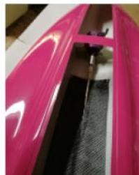
Eine nochmalige Kontrolle wird durchgeführt und wenn alles rund läuft, werden die Wellenanlage und der Motorhalter fest mit Epoxidkleber verklebt.
