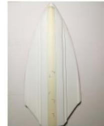
Sind die Maße aufgezeichnet werden sie je nach Modell und Klasse noch etwas angepasst. Jetzt werden die Löcher für das Ruderkoher und das Austrittsloch für die Wellenanlage gebohrt. Um das „Totholz“ der Wellenanlage in den Rumpfboden etwas einzulassen, wird dafür ein Schlitz gefräst.
