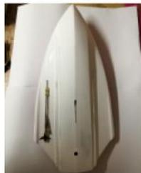
Jetzt wird der Wellenwinkel festgelegt. Dazu wird der Propeller auf die Welle geschraubt, anschließend wird die komplette Wellenanlage durch den Schlitz in den Rumpfboden eingeschoben. Zwischen Propellerblatt und Rumpfboden legt man ein 2mm Bohrer und kann dann das Ganze mit Sekundenkleber fixieren und mittig ausrichten.
