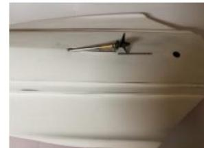
Danach wird der Motor an den Halter montiert, in den Rumpf gesetzt und genau zur Welle ausgerichtet. Dafür muss man den Motorhalter anpassen. Wenn alles fluchtet, wird alles wieder mit Sekundenkleber fixiert.
