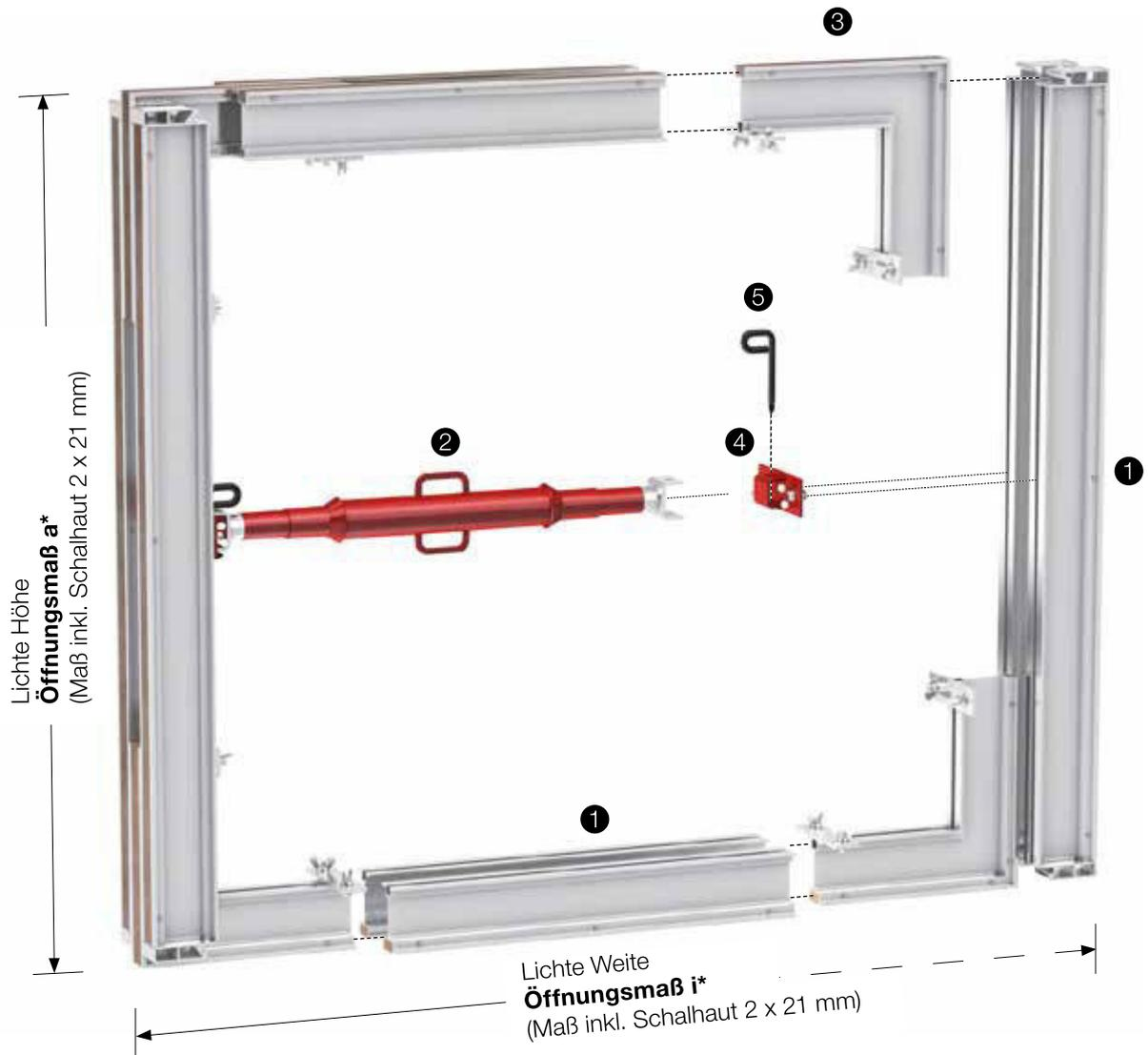
\* Die Schaleinheit kann auch um 90° gedreht verwendet werden. Die Öffnungsmaße a und i bezeichnen entsprechend die Höhe oder Breite der Schaleinheit. Die Strebe ist dabei immer waagrecht einzubauen.
