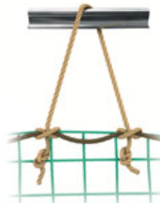
b) Zweisträngiges Aufhängegeseil Z (Seilbruchkraft \geq 15 \text{ kN} )
