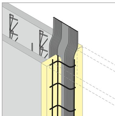
Bei Elementwänden werden die Betonschalen in der Konstruktion der Stremaform® Schalltrennfugen mit Fugenbandkorb berücksichtigt. Auch hier kann die Betonage in einem Betoniervorgang erfolgen.
