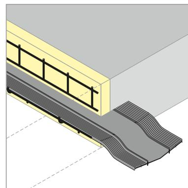
Bei Boden- bzw. Deckenplatten wird zur besseren Unterläufigkeit des Fugenbandes der Fugenbandkorb beidseitig um 15° aufgefäktet. Formteile und Übergänge in Wände werden werkseitig gefertigt und ergeben ein in sich schlüssiges System für das gesamte Bauwerk.
