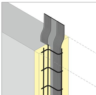
Der Einbau der Stremaform® Schalltrennfuge mit Fugenbandkorb in Ortbetonwänden ermöglicht die Betonage in einem, als auch in mehreren Abschnitten. Die Lage des bauseitigen Fugenbandes ist durch die Konstruktion der Elemente gesichert.
