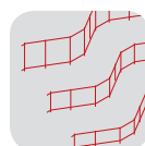
Abstandhalter für die obere Bewehrungslage
