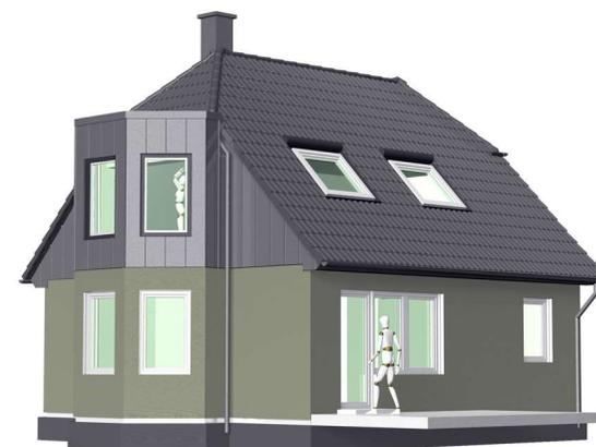
HOLZRAHMENBAU & WDVS-SYSTEM & 3 FENSTER UND AUFSATZROLLLADEN (REVISION NACH INNEN )
