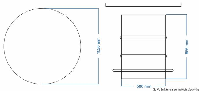
Die Materialien sind unter anderem aus Edelstahl und wetterfestem Holz. Individuelle, nach Kundenwunsch zu erstellende Beschriftungen werden mittels Hochleistungsfolien produziert. Der Stehtisch lässt sich in kurzer Zeit in 2 Teile zerlegen und ist so auch durch schmalere Türen zu transportieren. Kein Problem ist es individuelle Anpassungen vorzunehmen, so ist der Tisch z.B. mit oder ohne Fußstützring in Edelstahl lieferbar.
