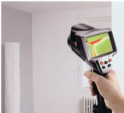
**Echtzeitfeuchtemessung** mit Wärmebildkamera und Funkfeuchtemodul
