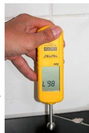
Messung der Baufeuchtigkeit unter Fliesen mit einer Hochfrequenzsonde bei einem verdeckten Rohrleitungsschaden
