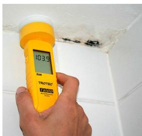
Messung der tiefer eingedrungenen Bauteilfeuchtigkeit mit einem Mikrowellensensor bei einer Mauerwerk-durchfeuchtung
