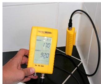
Messung der Ausgleichsfeuchte im Bohrloch mit einem Klimasensor bei einem verdeckten Rohrleitungsschaden
