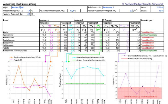
Beispiel für die Klimamessung einer Wohnung: Feuchte-kritische Räume werden auf einen Blick sichtbar.
