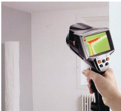
Die Echtzeitfeuchtemessung zeigt direkt die Taupunktprobleme*
