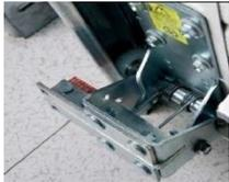
Sistema de seguridad anti rotura del cable
