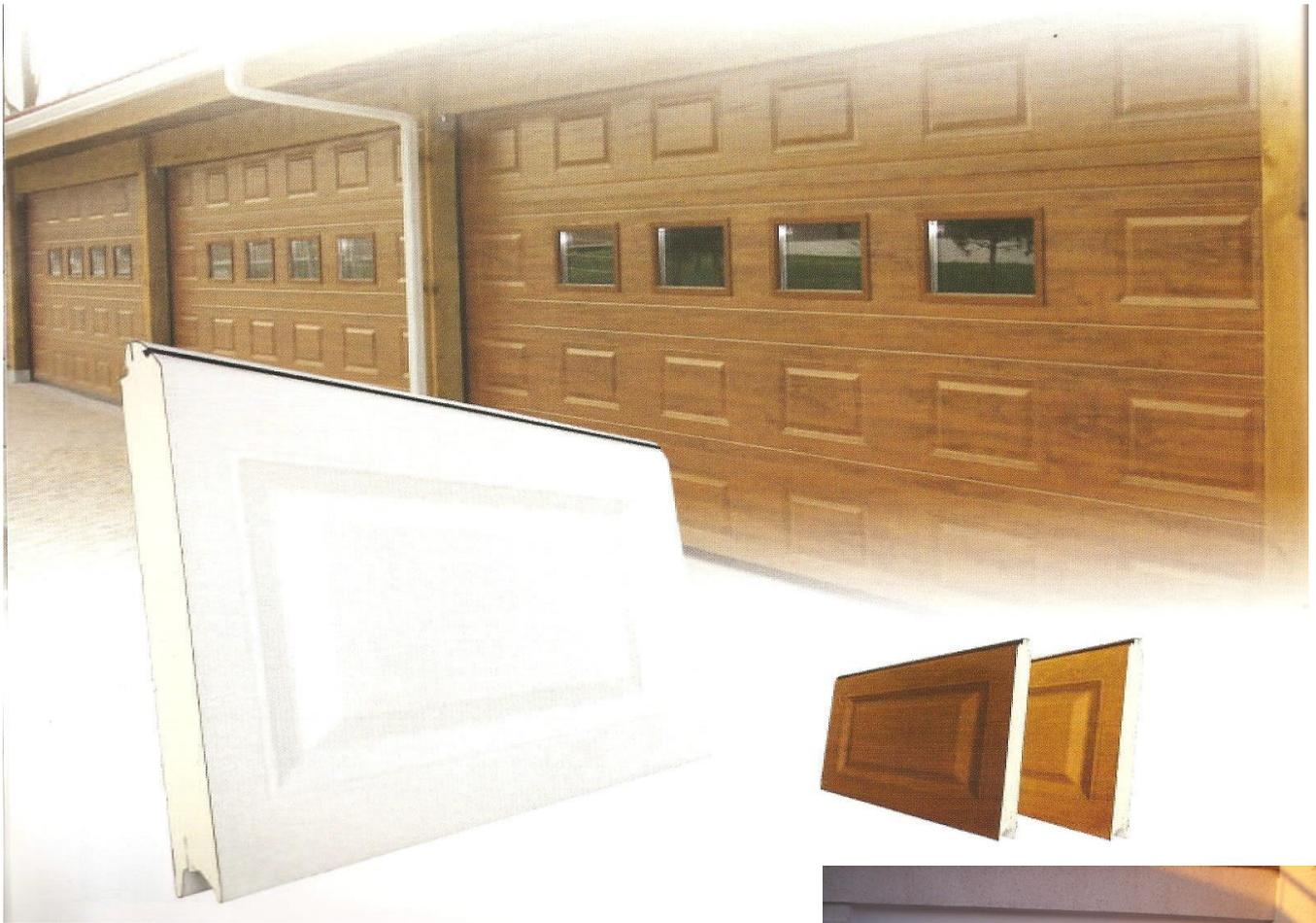
Panel sándwich con secciones de 500 o 610 mm de altura útil y grosor de 40 mm. de poliuretano expandido de gran densidad. Sistema anti pinzamiento previniendo cualquier situación de peligro Durante su movimiento.
