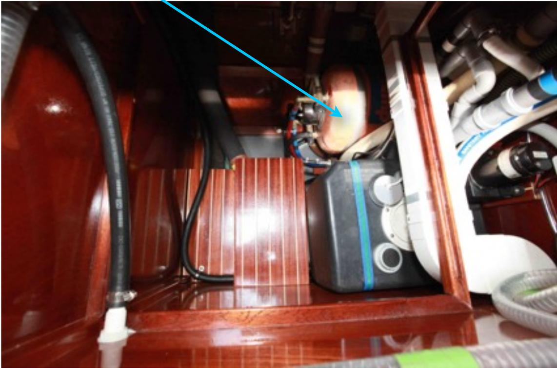
Der Boiler kann über 230 V Landstrom, oder durch den Kühlwasserkreislauf des Motors aufgeheizt werden.
