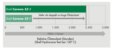
eine mehr als doppelt so lange Ölstandzeit gegenüber Shell Corena S2 R im Oxidationstest entsprechend dem Industriestandard ASTM D2272
