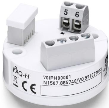
Der IPAQ-H ist ein universeller, galvanisch getrennter 2-Draht-Transmitter für Temperaturmessungen mit Widerstandsthermometern oder Thermometern mit Thermoelementen. Die Fehlerkorrektur-Funktion erhöht die Genauigkeit.
