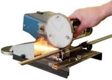
Tronçonneuse à meule RALI-CUT Pour tronçonner rapidement et avec précision les métaux, le bois et les plastiques ; le dispositif de serrage permet de fixer des sections rondes, carrées ou rectangulaires. Après le tronçonnage, la pièce peut être ébarbée avec la meule : meule autocollante facile à changer
