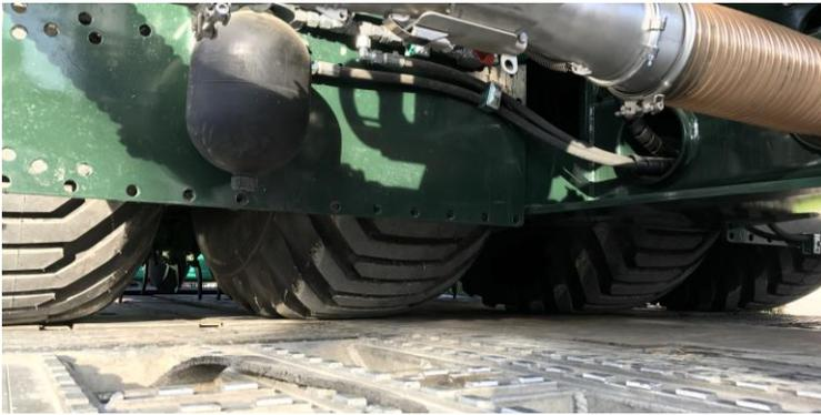
Das Fahrwerk besteht aus vier pendelnden Niederdruckreifen. Diese überdecken die gesamte Arbeitsbreite und reduzieren den Bodendruck auf ein Minimum. Die Oberfläche wird auf der gesamten Fahrbreite abgenommen.
