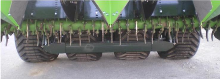
Alle Räder sind druckluftgebremst. Dadurch beträgt die max. Höchstgeschwindigkeit 40 km/h. Die Maschine ist durch den kurzen Radstand äußerst wendig.
