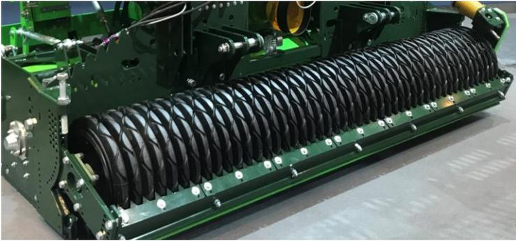
Gummierte Packerwalze mit Tiefenführung für Rotor und Tiefenablage für die Easy. Auch am Seitenhang ist die hangparallele Lage garantiert. Die Walze wiegt nur 250 kg und ersetzt damit den bisherigen Antrieb der Legeorgane. Durch die Führung am Boden ist der Schlepper im Feld unbelastet und keinerlei Gewicht auf der Hinterachse. Eine verstellbare Prallschiene ist für die Einebnung voraus und einen ruhige Lauf der Maschine vorhanden. Straßenfahrt ohne Achslastüberschreitung möglich.
