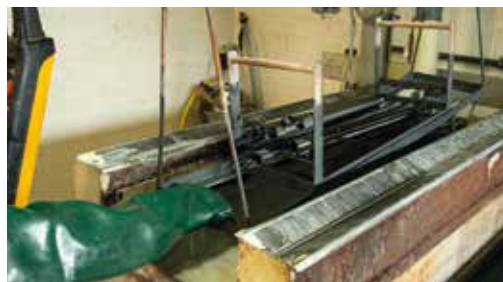
Bis zu zwölf Gewehrläufe schaffen die Becken der Tauchbrünierung auf einmal
