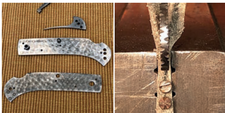
Links die Titanplatinen mit dem Sonnenschliff, rechts die Feilarbeit auf der Feder und die verzierten Schrauben.
