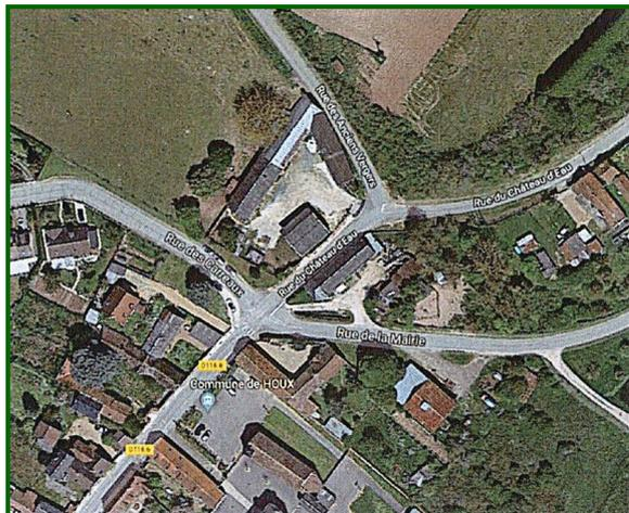
Cette approche de carrefour nécessite toutefois un renfort de signalisation directionnelle permettant à l'usager non riverain de comprendre que la rue de la Mairie plus large et moins urbanisée constitue l'axe principal en montée en direction de Hanches et de Gas. Une réflexion sur les aménagements de sécurité sur ce carrefour est souhaitée pour rééquilibrer le trafic et éviter l'utilisation de la rue du Château d'Eau comme une voie d'évitement par les usagers de passage."
