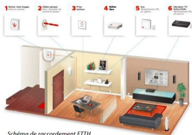
Schéma de raccordement FTTH
