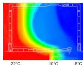
Die am häufigsten von Herstellern empfohlenen Aufsatzrollläden halten Wärme im Inneren des Gebäudes. In der Schicht zwischen dem Panzer des Rollladens und Fenster entsteht ein Luftpolster, das die perfekte Dämmschicht, d.h. spezieller Puffer, sowohl für Heiß- als auch Kaltluft bildet.
