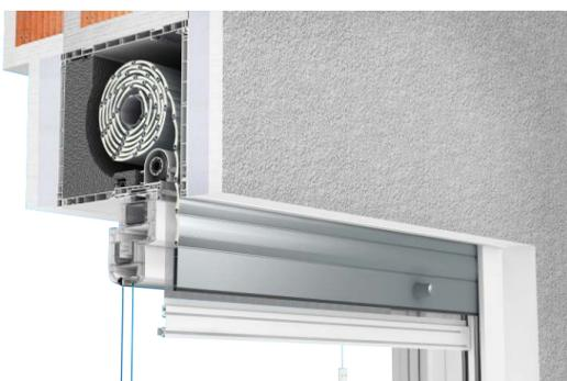
Der TP1000K-Rollladen ist an der Innen- und Außenseite eingebaut. Die Stirnprofile sind zusätzlich geriffelt und mit den Putzleisten ausgestattet, die den Einbau vereinfachen. Die Revisionsklappe wird bei diesem Einbau von unten eingesetzt und Bedienung des Rollladens erfolgt vom Inneren des Raums.
