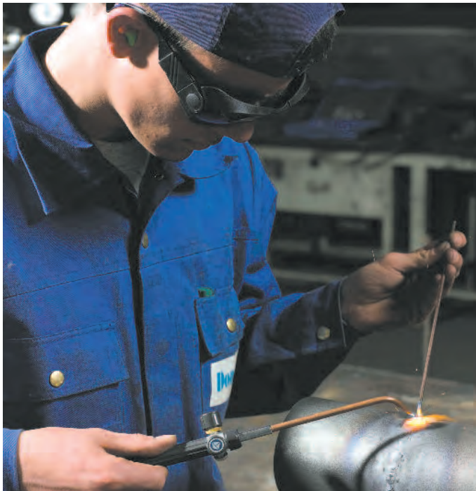
MINITHERM® Autogen- Schweißen an Rohren bis 4,0 mm Materialstärke.
