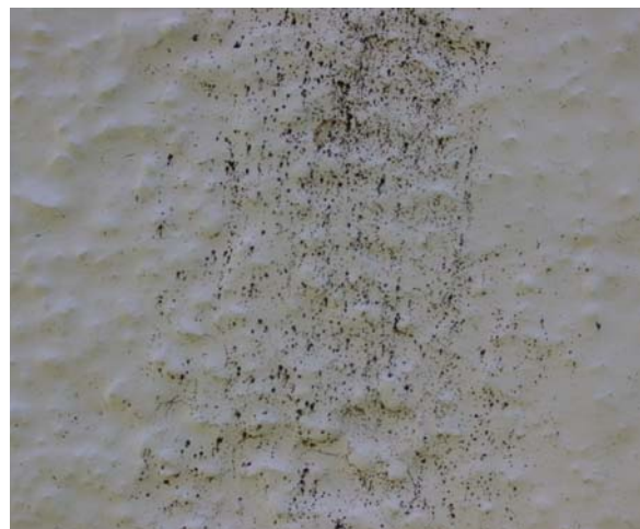
Bild 2: Fotografische Aufnahme eines biologischen Bewuchses der Kategorie + (Bild links) sowie der Kategorie ++ (Bild rechts) auf Probekörpern in der Freilandversuchsstelle in Holzkirchen.
