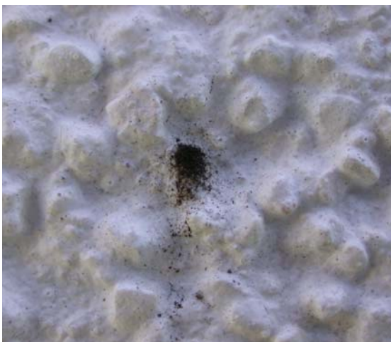
Bild 2: Fotografische Aufnahme eines biologischen Bewuchses der Kategorie + (Bild links) sowie der Kategorie ++ (Bild rechts) auf Probekörpern in der Freilandversuchsstelle in Holzkirchen.
