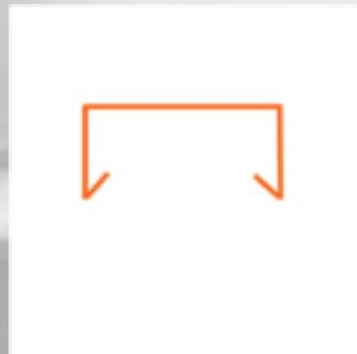
Une couvertine (appelée aussi coiffe) est un élément de protection, d'étanchéité et de décoration de la partie supérieure d'un muret ou d'un toit terrasse.
