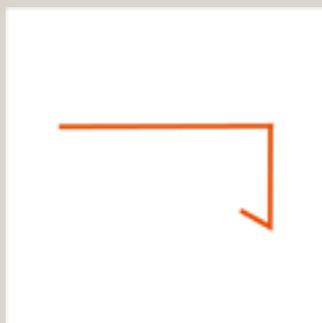
Une bande de rive permet un recouvrement esthétique et efficace de l'accrotère béton.
