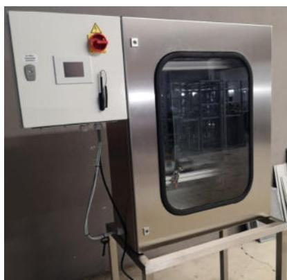
■ Versuchsanlage zur Behandlung von Textilproben
