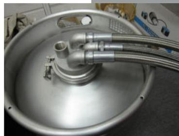
■ Spezial KEG Armatur mit innenliegendem Wärmetauscher
