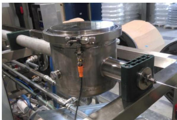
■ Drahtreinigungsanlage mit dem Lösemittel Butylal
