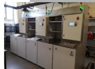
**Universell einsetzbare Anlage zur Reinigung von Einzelteilen und Schüttgut im klassischen Verfahren mittels Dreh-/Schwenkvorrichtung.**
