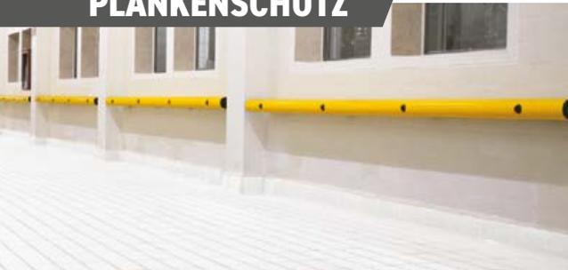
Der innovative Plankenschutz schützt Maschinen, Gebäude und Inventar effektiv und beugt Anfahrsschäden sowohl im Innen- als auch im Außenbereich vor. Die Besonderheit dieses Plankenschutzes liegt darin, dass er ebenso an der Wand wie auch am Boden einsetzbar ist. Der Plankenschutz wird verdeckt befestigt und ist abgedichtet nach IP55. Nicht brennbar gemäß Vorschrift UL94-V0.
