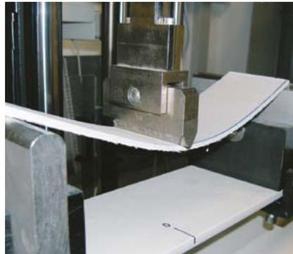
Das bei der Biegeprüfung aufgenommene Bild beweist eindrucksvoll, welchen extremen Kräften eine an sich starre und harte PCI-Bodenausgleichsmasse HSP 34 widersteht, wenn sie mit PCI Armiermatte GFM + GFS im System verstärkt ist.
