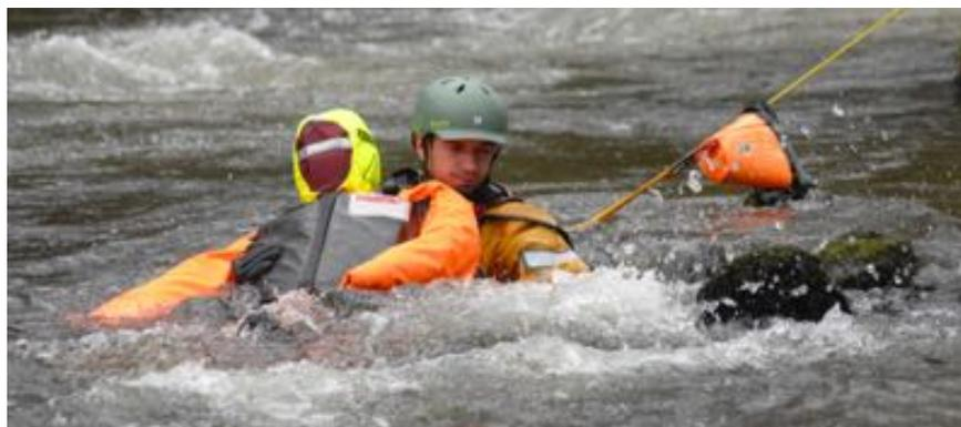
El maniquí Search & Rescue está hecho con la misma especificación que el modelo Man overboard y tiene exactamente el mismo nivel de flotabilidad. Ambos modelos tienen dos bolsillos en la parte inferior de las piernas del mono: para hacer que el maniquí flote horizontalmente, simplemente mueva las 6 piezas de espuma del cofre frontal a los bolsillos de cada pierna.
