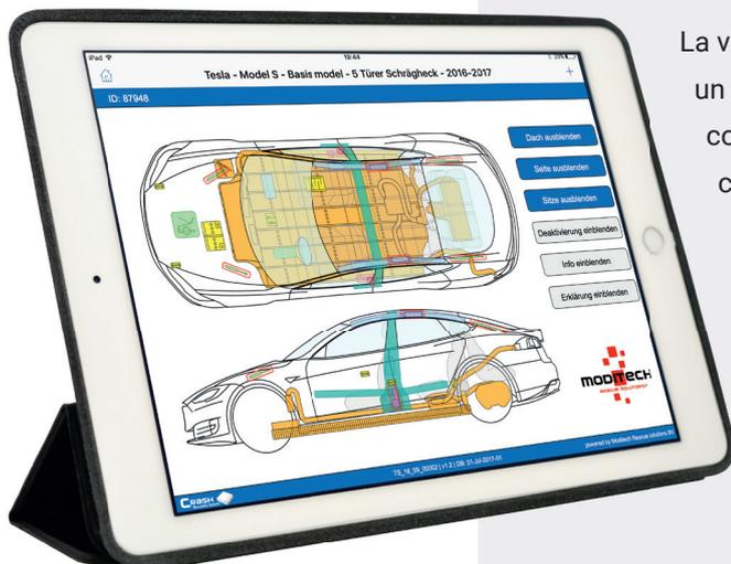
La vista interactiva superior y lateral del vehículo muestra de un vistazo todos los sistemas de seguridad presentes y otros componentes relevantes (como la batería, el depósito de combustible, etc.).
