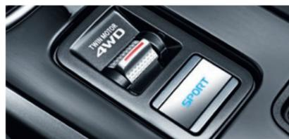
Ihnen stehen drei Allradmodi zur Verfügung: NORMAL, SNOW und LOCK. Der SNOW-Modus sorgt für spurtreues Anfahren sowie sicheres Kurvenverhalten bei winterlichen und rutschigen Straßenbedingungen, während der LOCK-Modus bei schwierigen Untergrundbedingungen für eine maximale Traktion sorgt. Der zusätzliche Fahrmodus SPORT sorgt mit direkterem Ansprechverhalten für sportliches Fahren mit sicherem Kurvenhandling.
