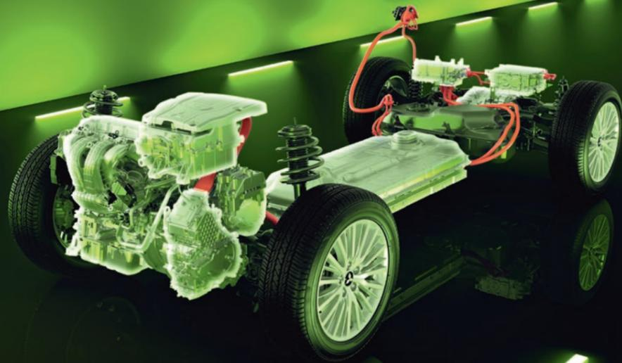
Im Outlander Plug-in Hybrid arbeitet der starke 2.4 Liter Benzinmotor (99 kW/135 PS) mit einem maximalen Drehmoment von 211 Nm nach dem sogenannten Atkinson-Zyklus und weist einen höheren Wirkungsgrad sowie eine höhere Energieeffizienz auf. Kombiniert wird der neue Benzinmotor mit zwei leistungsfähigen Elektromotoren –
