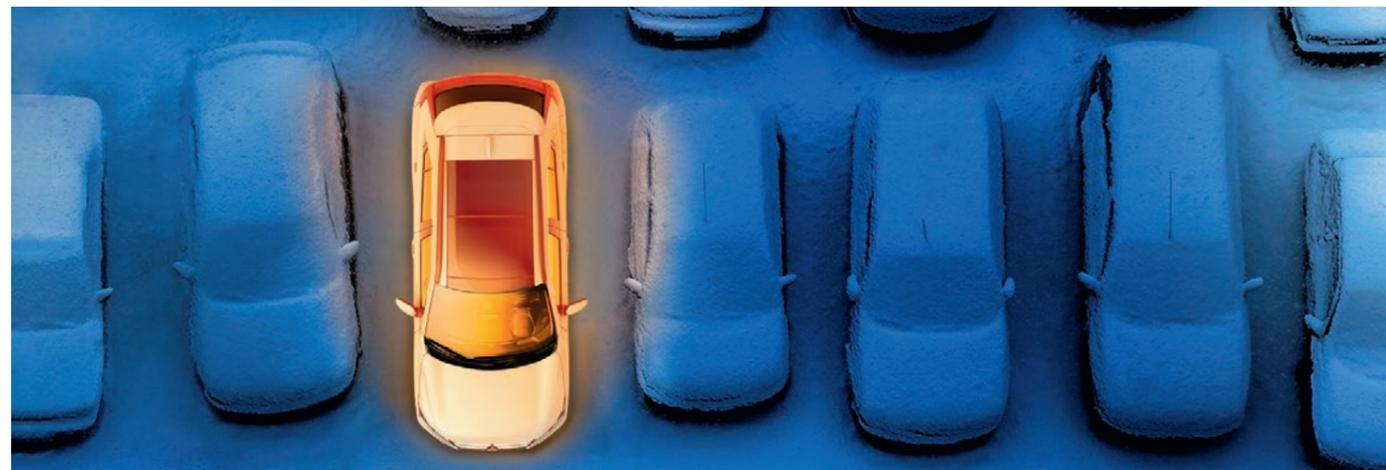
Ein Komfort, der überzeugt. Motorunabhängige Standheizung mit digitaler Vorwahrer und/oder Fernbedienung, damit Sie auch an kalten Tagen mit eisfreien Scheiben und angenehm warmem Innenraum starten. Zudem schonen Sie den Motor, da ein Kaltstart vermieden wird.
