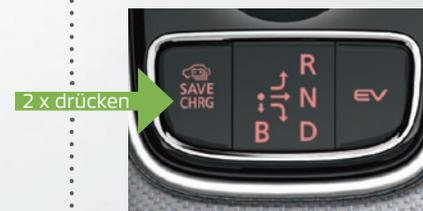
Durch erneutes Drücken der „SAVE/CHRG“-Taste wird der Charge-Modus aktiviert. Der Verbrennungsmotor treibt das Stromaggregat an und der Akku wird während der Fahrt geladen. In ca. 40 Minuten können maximal 80% der Batteriekapazität geladen werden.
