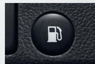
Durch Betätigen des Tankschalters links unterhalb der Lenksäule starten Sie die elektronische Tankentriegelung, nach deren Abschluss ist das Fahrzeug bereit zum Tanken. Die Entriegelung wird im Multifunktionsdisplay angezeigt.
