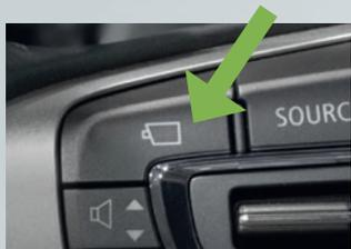
Dieser Schalter aktiviert die 360-Grad-Kamera<sup>1</sup> und verändert bei mehrmaligem Drücken den Sichtbereich der 360-Grad-Umgebungs-kameras.
