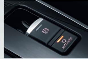
Die Auto-Hold-Funktion verhindert, dass das Fahrzeug ungewollt wegrollt, ohne dass der Fahrer die Bremse betätigen muss. Den optimalen Bremsdruck wählt das System automatisch in Abhängigkeit vom Gefälle bzw. von der Steigung. Der Fahrer kann den
