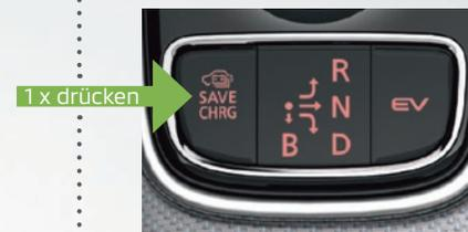
Durch Drücken der „SAVE/CHRG“-Taste wird der EV-Modus außer Kraft gesetzt, um die Akkuleistung für später aufzusparen. Der Save-Modus greift erst bei weniger als 90% Batterieladestand.
