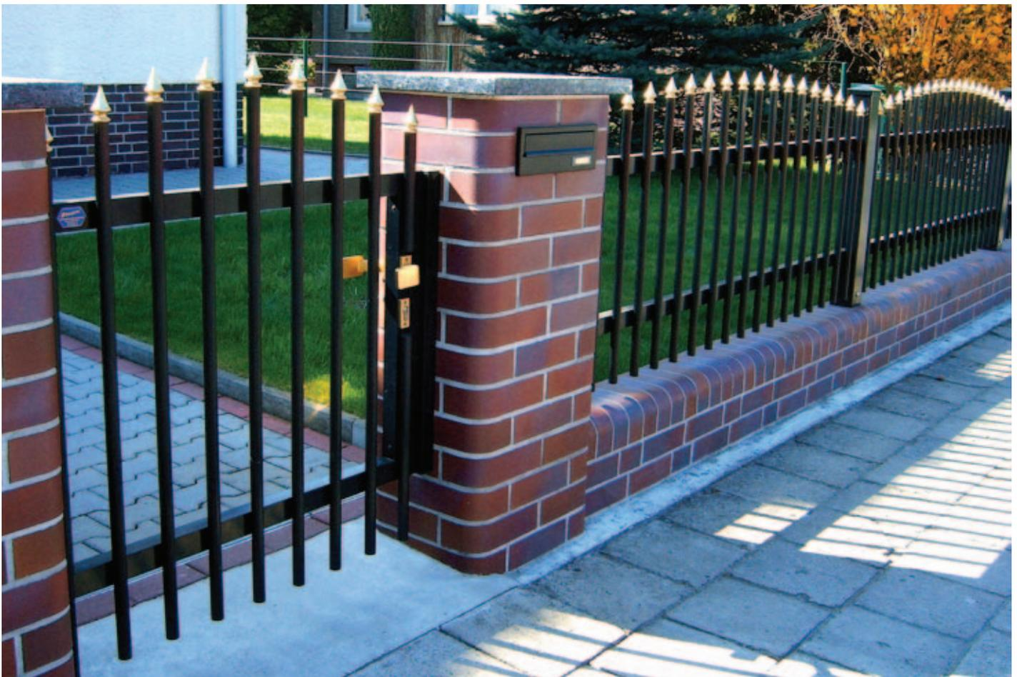
Elegante Aluminiumrundrohre mit einem Durchmesser von 26 mm werden mittels Edelstahlschrauben auf dem Aluminiumquerriegel von 50x40 mm, verdeckt verschraubt.
