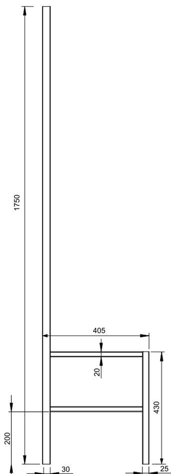
Fenólico en horizontal sale 15 mm y tiene 12 mm de grosor por 170 mm de ancho.
