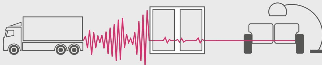
\*\*\* Basis der Rechnung: Erhöhung des Schalls um 10 dB = Verdopplung der subjektiv empfundenen Lautstärke (LfU). GENEО reduziert Schall um 47 dB.
