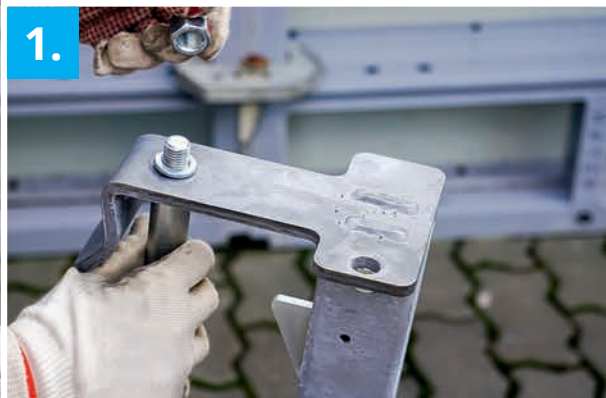
1. Dorn aus Position für Hohlwandanwendung entfernen
