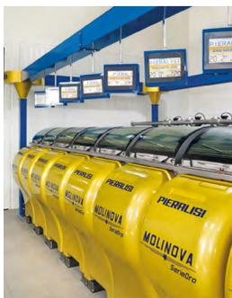
La fase di gramolatura che segue quella della frangitura, completa il processo di preparazione delle paste per l'estrazione e contribuisce allo sviluppo delle proprietà chimico-fisiche ed organolettiche dell'olio estratto. Ottimizza i profumi ed i sapori ed è fondamentale per la resa estrattiva finale.
