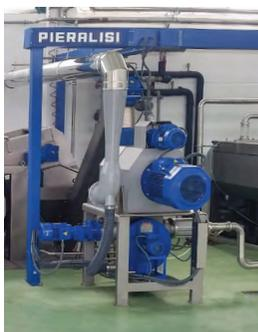
Con i processi di Frangitura e Gramolatura si entra nelle fasi più delicate del processo di produzione dell'olio d'oliva.
