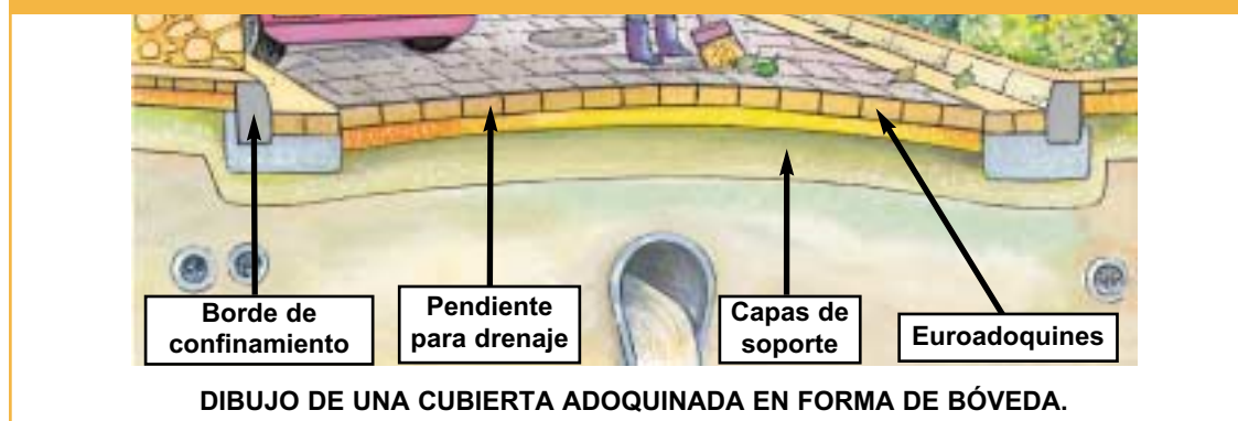
Figura 1. SECCIÓN TRANSVERSAL DE CALZADA CON EUROADOQUIN
