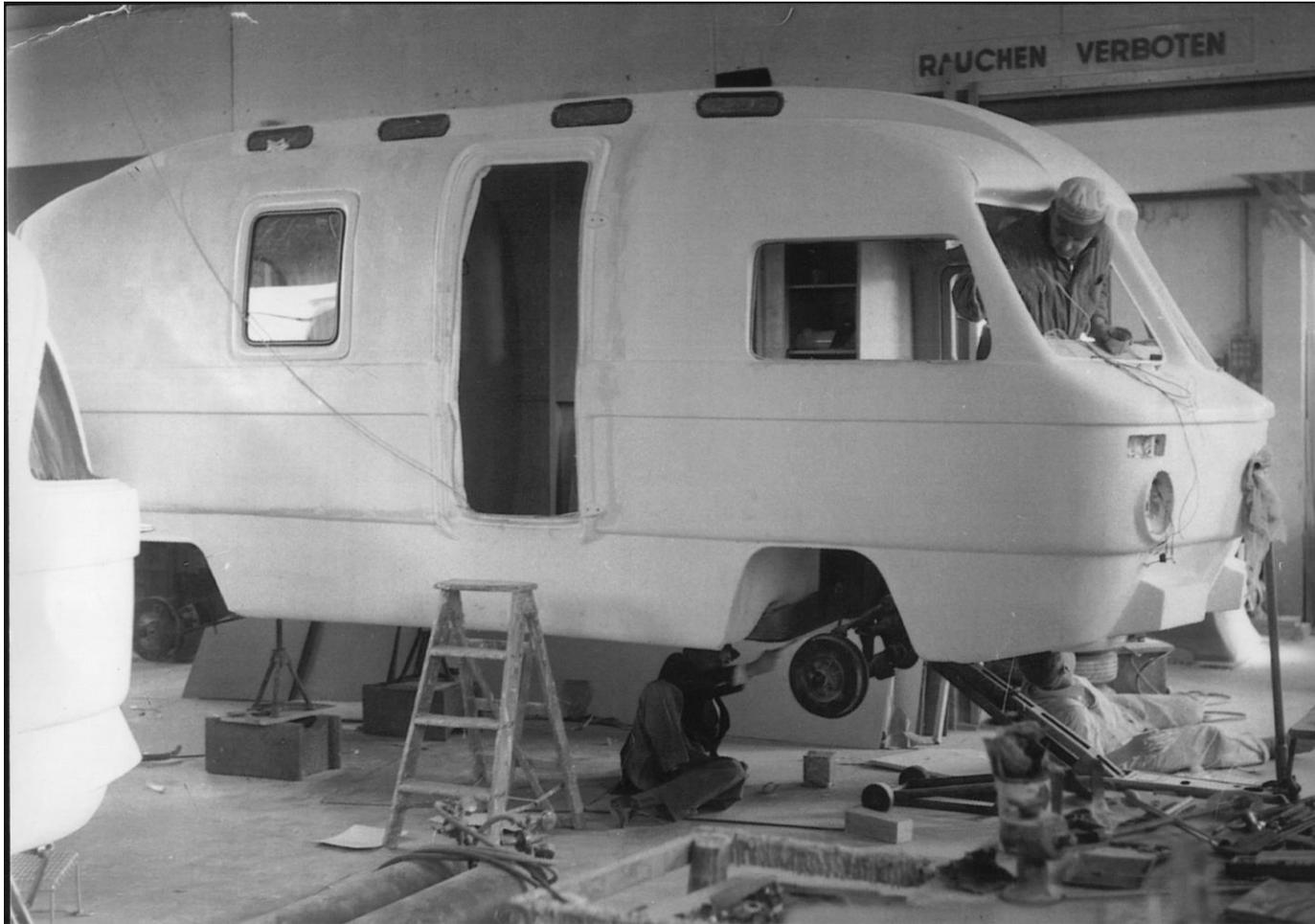
Der Bau des ersten ORION in der Werkshalle in Detmold-Losbruch. Deutlich ist noch der Ansatz des SULEICA- Hinterteils rechts neben der Tür zu sehen
