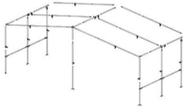
▲ ... Gestänge aus Stahlrohr 25mm, mit zahlreichen Dach- und Seitenwandstangen.
