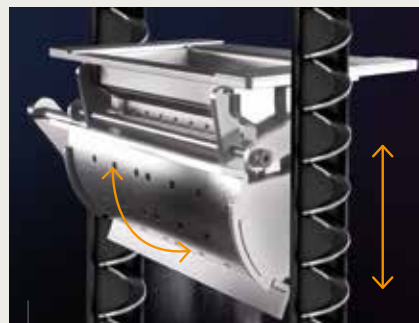
En même temps que le vidage du brasier, on a aussi l'activation des turbulateurs qui raclent les résidus de suie sur les échangeurs (uniquement sur certains modèles hydrauliques)
