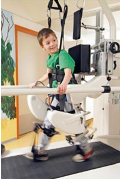
Der Name dieser roboterunterstützten Gangorthese ist an das Lokomotionstraining angelehnt, ein Gehtraining auf einem Laufband (Foto: Hocoma)
