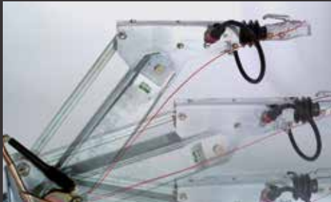
Höhenverstellbare Zugdeichsel (Kugelkopf-Kupplung und DIN-Zugöse nicht inklusive)
