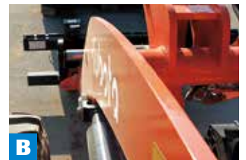
B Sicht auf die Schnellwechsler-Verriegelungsbolzen
