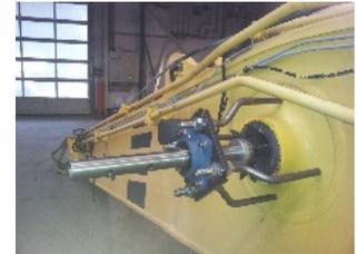
Durch unsere mobile Bohr und Schweißtechnik haben wir die Möglichkeit ausgeschlagene Bohrungen, Bolzenlagerstellen und Buchenpassungen vor Ort instand zusetzen.
