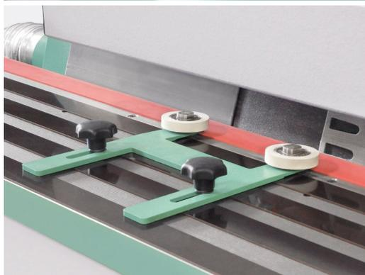
Eine spezielle Vorrichtung vereinfacht das serielle Schleifen von Kleinteilen und Glasleisten
