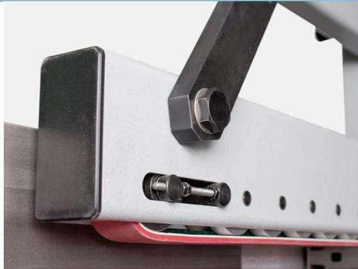
An Stelle von Druckrollen kann ein oberes Transportband das Schleifen von Kleinteilen erheblich erleichtern
