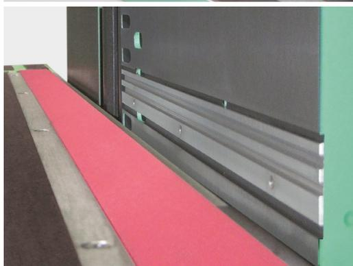
Der genutete Einlauf-Anschlag ermöglicht das Schleifen von Kanten mit Furnierüberständen
