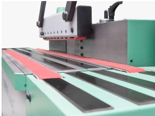
Für breitere Werkstücke kann ein zusätzliches unteres Transportband von grossem Nutzen sein
