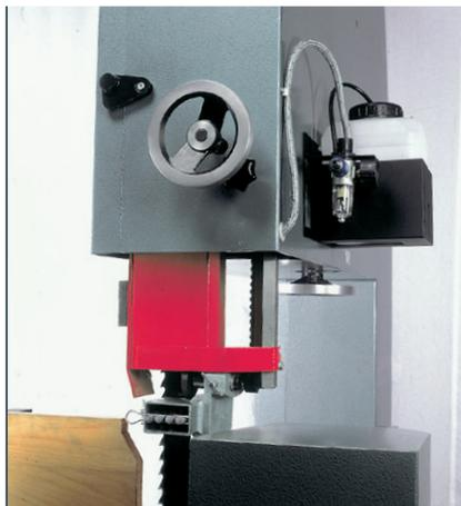
Bei vielen Hölzern wird die Standzeit und Leistung des Sägeblattes durch Verwendung eines Sprühmittels wesentlich verbessert. Eine geeignete Sprühvorrichtung ist im Sonderzubehör lieferbar.
