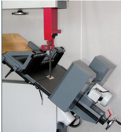
Der große, bis zu 45° schrägstellbare Arbeitstisch erlaubt das Sägen von Keilleisten. Der Rollenanschlag ist im Sägeblattbereich ausgeklinkt.
