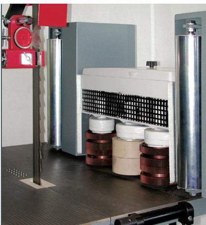
Mit dem zuverlässigen Vorschub der 3 aufeinander abgestimmten Doppelwalzen und den hohen Andruckrollen können dünne Lamellen präzise getrennt werden. (Sägefurniere, Treppenwangen, Instrumentenbau etc.).
