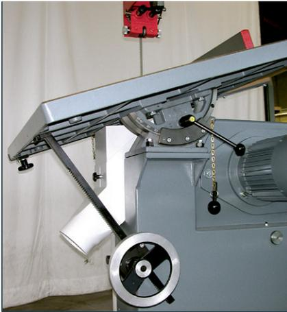
Für den Modellbau bietet HEMA – als Zubehör – die Präzisionsschwenkeinrichtung bis 45°, mit graviertem Skala, Schnellklemmung und Handradverstellung.
