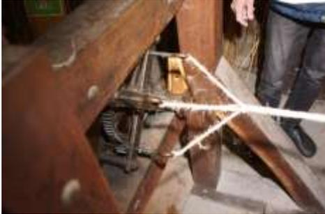
Durch eine Drehbewegung wird aus 4 Fäden ein erstes Seil. Aus 4 Seilen wird ein dickes Seil oder Tau. Um ein Seil von 100m Länge zu fertigen, benötigt man ca. 10 Personen.
