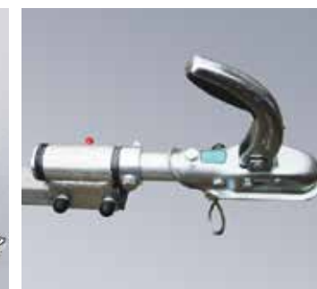
Tête d'attelage pivotante pour utilisation hors route (sans homologation type pour la route)
