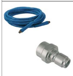
**MANGUERAS** de plástico termoesfiable con roscas macho de 1/2". Disponible a partir de 5m y hasta 35. Se conectan a los equipos de limpieza a través de **ENLACES RÁPIDOS** de acero inoxidable y pueden trabajar a una temperatura de hasta 70°C y una presión de hasta 50Bar.
